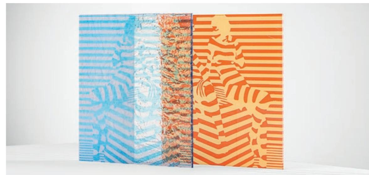
Siebdruck mit keramischen Farben der *Kollektion 140*, Transparent und Opak. Die Glasoberfläche wurde anschließend mit Sandstrahl- und Schmelztechniken bearbeitet, um partiell die Transparenz und Lichtdurchlässigkeit zu verändern.
