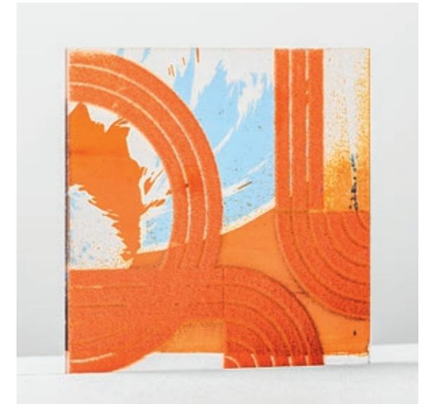
Keramischer Siebdruck in 3 Farben, Glaspulverdruck
