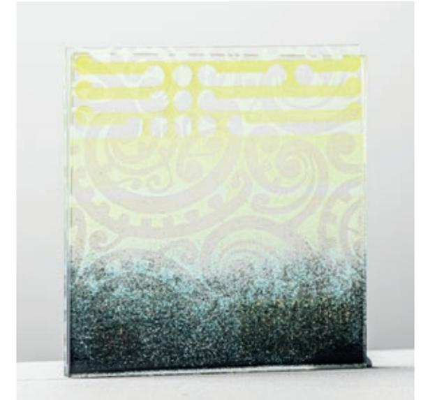
Glaspulverdruck auf Float-Glas, Zwei-Scheiben-Fusing
