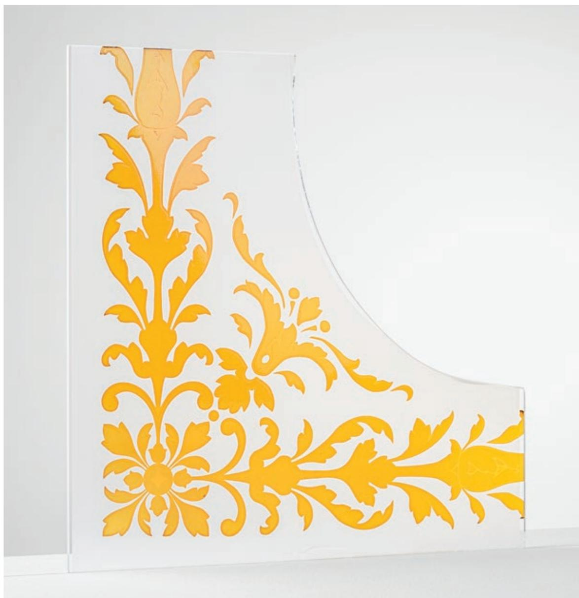
Kombinationsverfahren mit keramischen Pigmenten der *Kollektion Transparent* und *Ätzimitation*. Das Motiv wurde einem geätzten Überfangglas-Fenster entnommen, digital nachgezeichnet und mittels Siebdruck auf Float-Glas übertragen.
